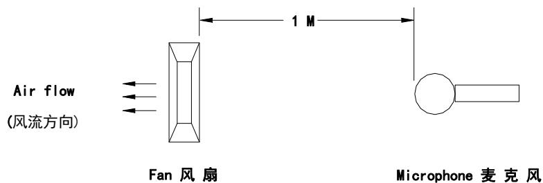
(在背景噪音不超过 18dB (A) 的无响室内, 将待测风扇通入额定的工作电压, 悬掉入空中, 将麦克风放于风扇同一平面且离待测风扇进风口一米处进行测试其 B&K 值)
