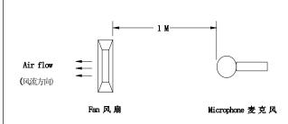
(在背景噪音不超过 18dB(A)的无响室内,将待测风扇通入额定的工作电压,悬掉入空中,将麦克风放于风扇同一平面且离待测风扇进风口一米处进行测试其 B&K 值)
