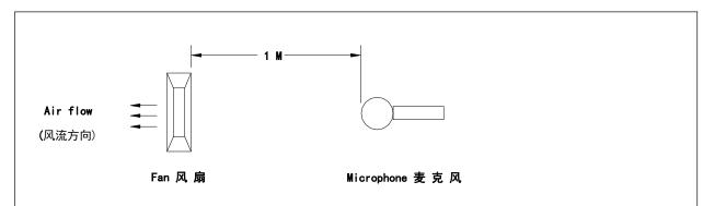
(在背景噪音不超过 18dB (A) 的无响室内,将待测风扇通入额定的工作电压,悬掉入空中,将麦克风放于风扇同一平面且离待测风扇进风口一米处进行测试其 B&K 值)
